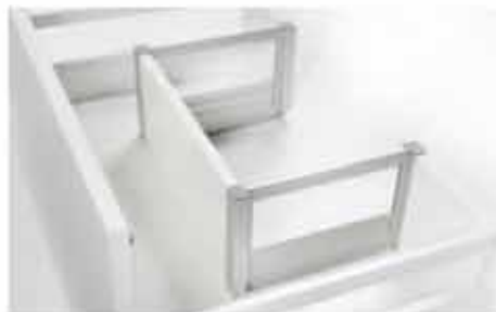
Het uitgezaagde rugwandstuk wordt gerecupereerd en vormt samen met de op maat gezaagde aluminium profielen een mooi afgewerkte lade-uitsparing.
